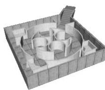
Ajout des structures légères immergeables qui constituent le bassin thermoludique
