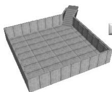
Enveloppe béton étanche
